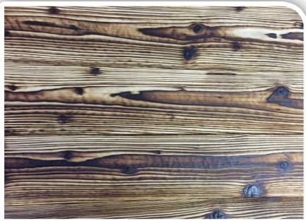
PL | **BALTICA 1 (BAL-1)** - opalana, dwukrotnie szczotkowana, impregnowana. Powstaje szczotkowana struktura drewna z widocznym usłojeniem i sękami w kolorze jasny brąz.
