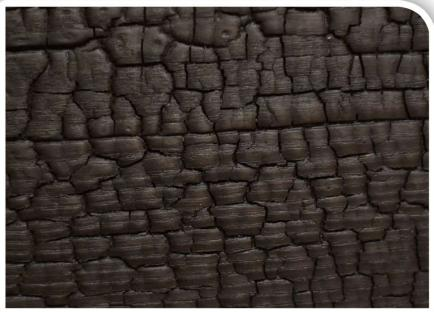
PL | **THERMO JESION (TJ-1)** - opalana, impregnowana. Powstaje zwęglona struktura drewna.
