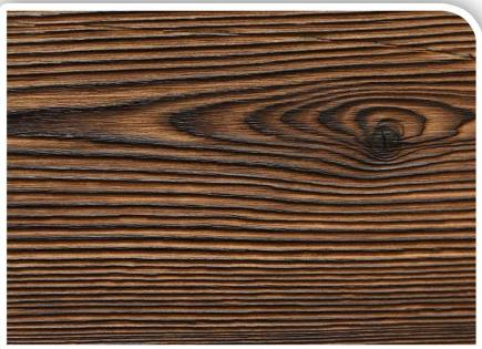
PL | **MAZURIA 1 (MAZ-1)** - opalana, dwukrotnie szczotkowana, impregnowana. Powstaje szczotkowana struktura drewna z widocznym usłojeniem i sękami w kolorze jasny brąz.
