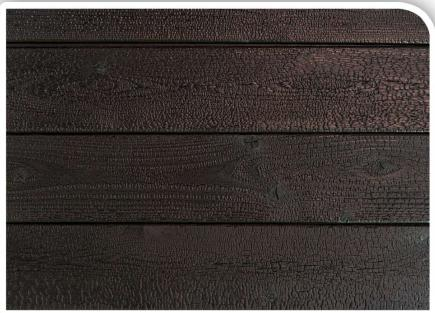
PL | **SILESIA 1 (SIL-1)** - opalana, impregnowana. Powstaje zwęglona struktura drewna.
