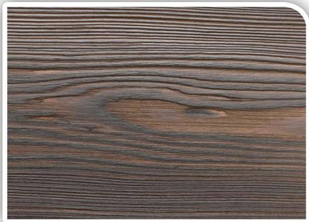
PL | **MAZURIA 3 (MAZ-3)** - opalana, dwukrotnie szczotkowana, dobarwiona podczas impregnacji, polerowana. Powstaje szczotkowana struktura drewna z widocznym usłojeniem i sękami. W dowolnym kolorze RAL, który wynika z pigmentu barwnika dodawanego do środka impregnującego.
