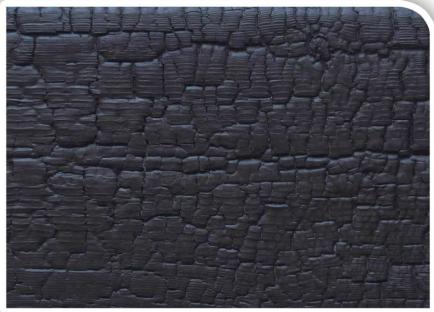
PL | **THERMO SOSNA (TS-1)** - opalana, impregnowana. Powstaje zwęglona struktura drewna.
