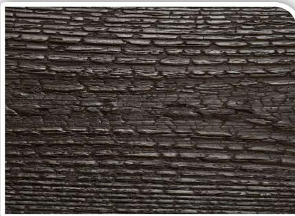
PL | **KARPATIA 3 (KAR-3)** - opalana, szczotkowana, opalona powtórnie, impregnowana. Powstaje szczotkowana struktura drewna, z widoczną warstwą zwęgloną oraz widocznym usłojeniem i sekami.
